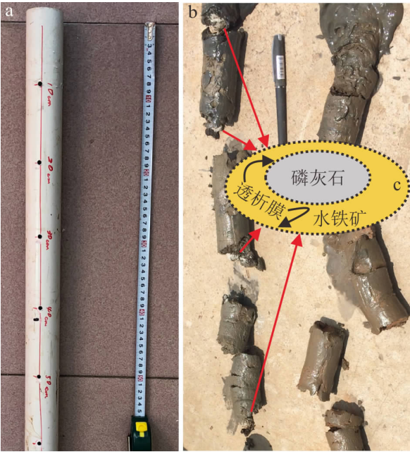
a—实验装置;b—实验样品;c—样品袋结构示意图。
