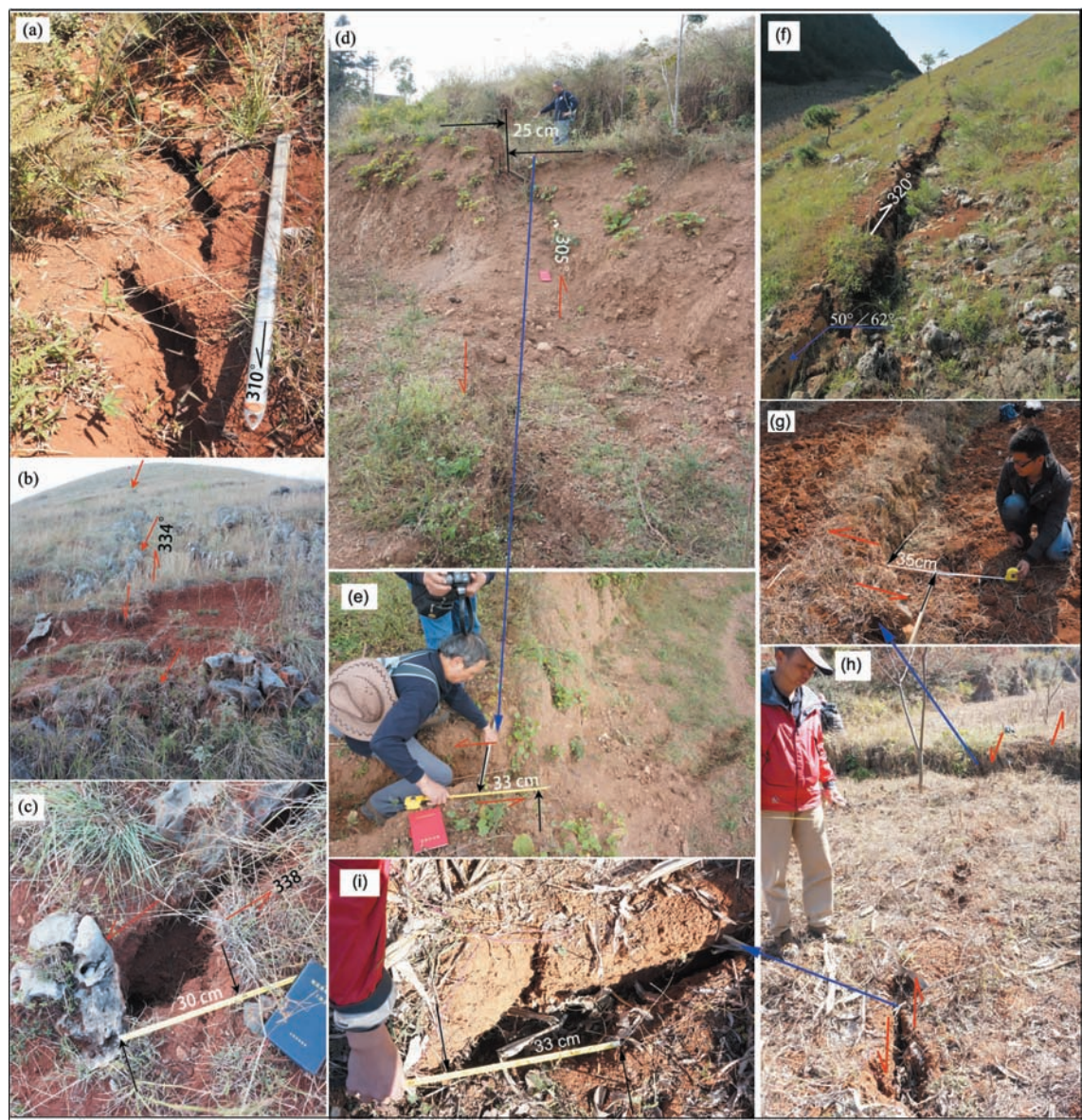
(a)—(c)谢家营盘地表破裂;(d)、(e)一大凹子南地表破裂;(f)——(i)小垭口段地表破裂。照片(h)镜向东南。 图 3 鲁甸地震北西向地表破裂典型照片
